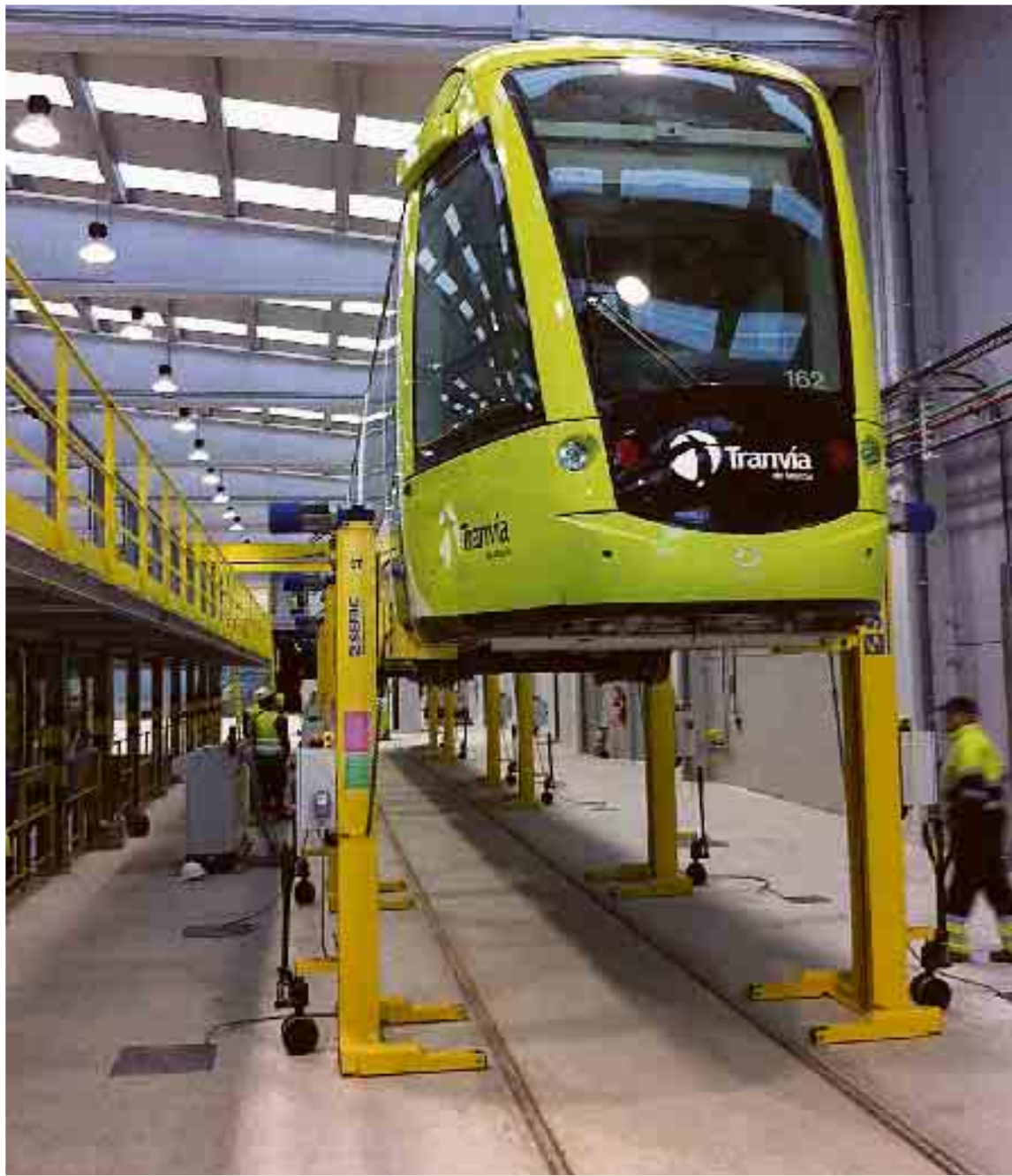
Los 'bogies' o grúas de levantamiento del tranvía permiten su revisión técnica. Ayuntamiento de Murcia
