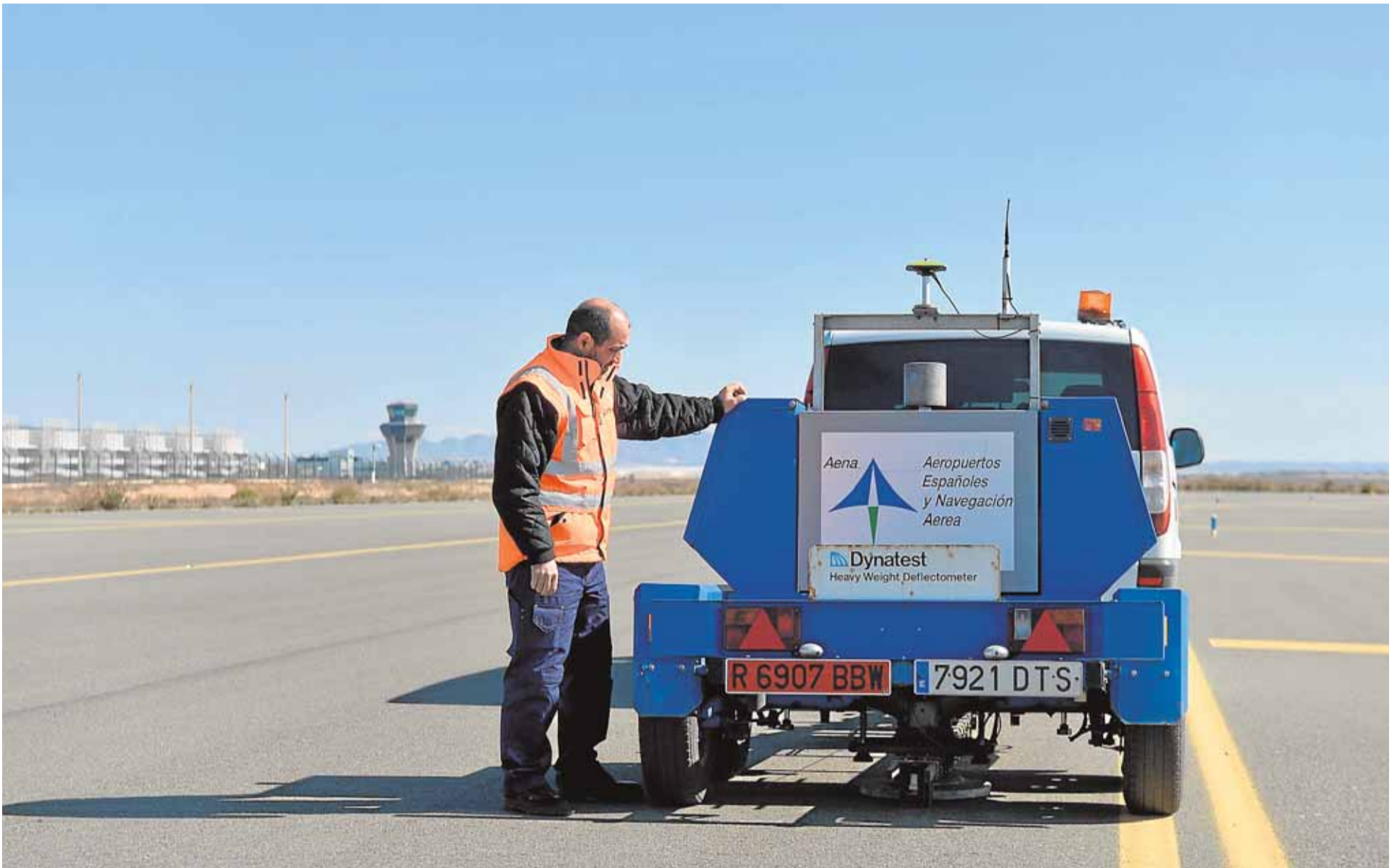
Un camión laboratorio de Aena mide estos días la resistencia de la pista, realizando pruebas con un aparato hidráulico cada 40 metros. :: FOTOS NACHO GARCÍA / AGM
